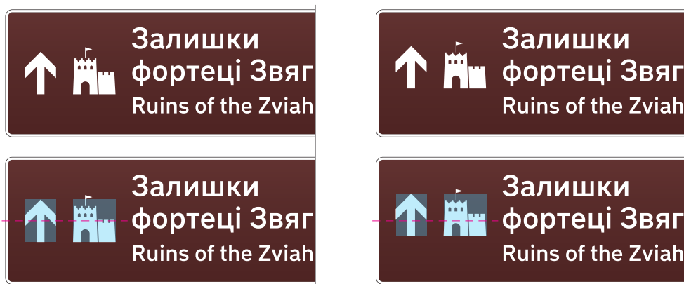
Ілюстрація 6.11 — Приклади оптичної компенсації: ліворуч — без компенсації, стрілка та піктограма, вирівняні за геометричним центром, здаються розташованими нижче середини; праворуч — з компенсацією, стрілка та піктограма підняті вище середини знака, здаються розташованими за центром
